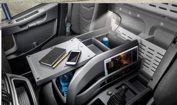
Neu entwickeltes ergonomisches Office-Modul mit Flaschen- und Dokumentenhalter, klappbarem Arbeitstisch und LED-Leseleuchte
